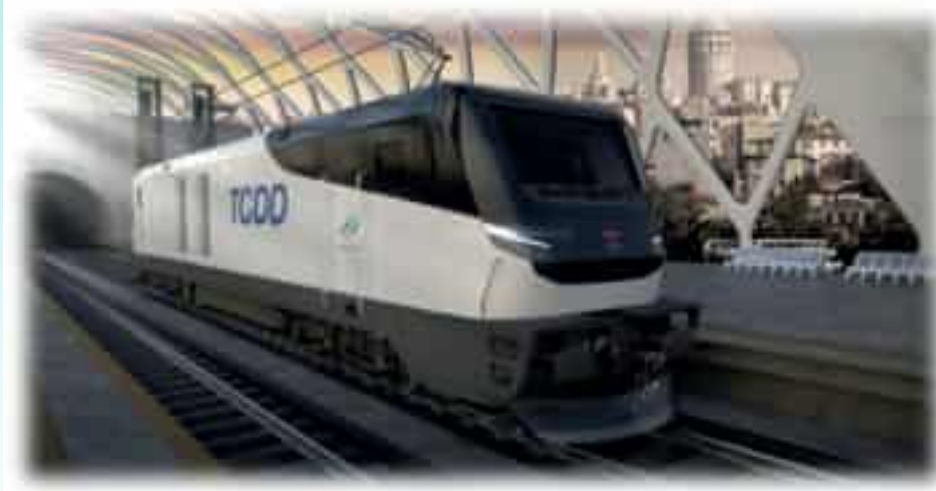
Co-Co Aks Tertibatına Sahip Milli Lokomotif
